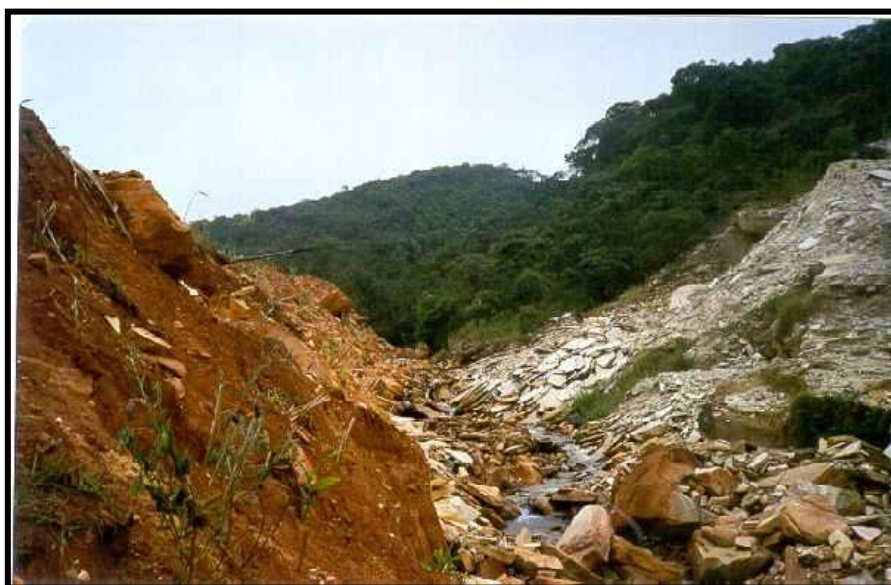
Figura 2 - A escavação dos depósitos de quartzito envolve a remoção do solo superficial e das rochas do capeamento.
