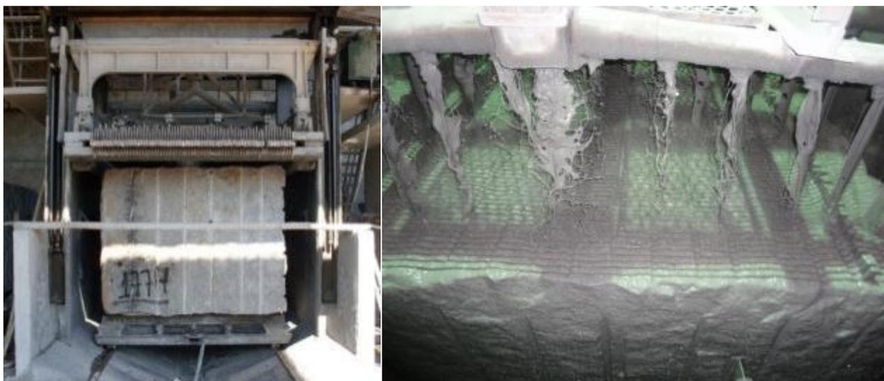
Figura 1 - Tear Multilâmina. Fotos: CETEM.
