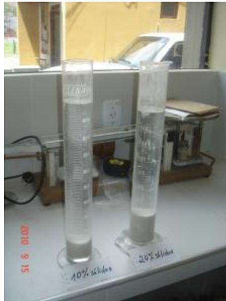
Figura 1 – Detalhe do ensaio de sedimentação realizado com 10, 20 e 30 % de sólidos.
