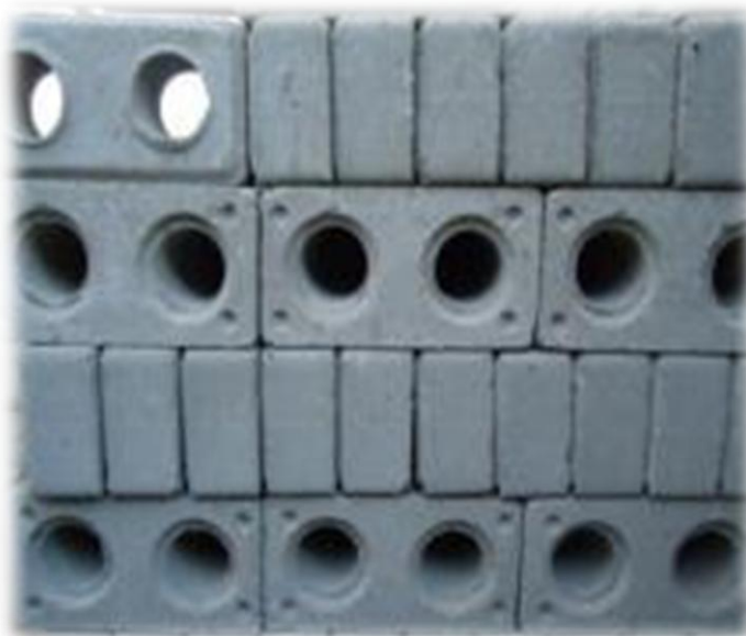
Figura 3 - Tijolos ecológicos de solo-cimento. Fonte: Própria (2012).
