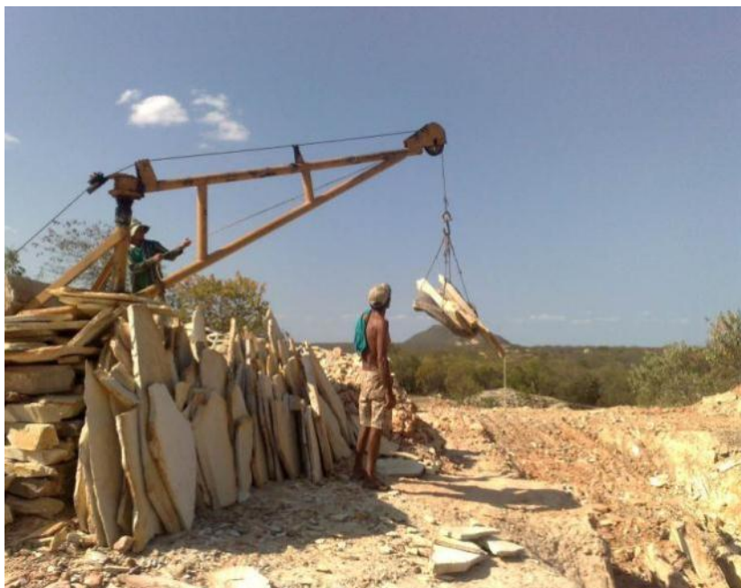
Figura 8 - Guincho utilizado para erguer as placas da base da cava à superfície. Fonte: CETEM/MCTI
