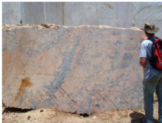
Fotografia 1A – Detalhes de um bloco de rocha ornamental (pegmatito) na localidade do Sítio Trapiá (Currais Novos-RN).
