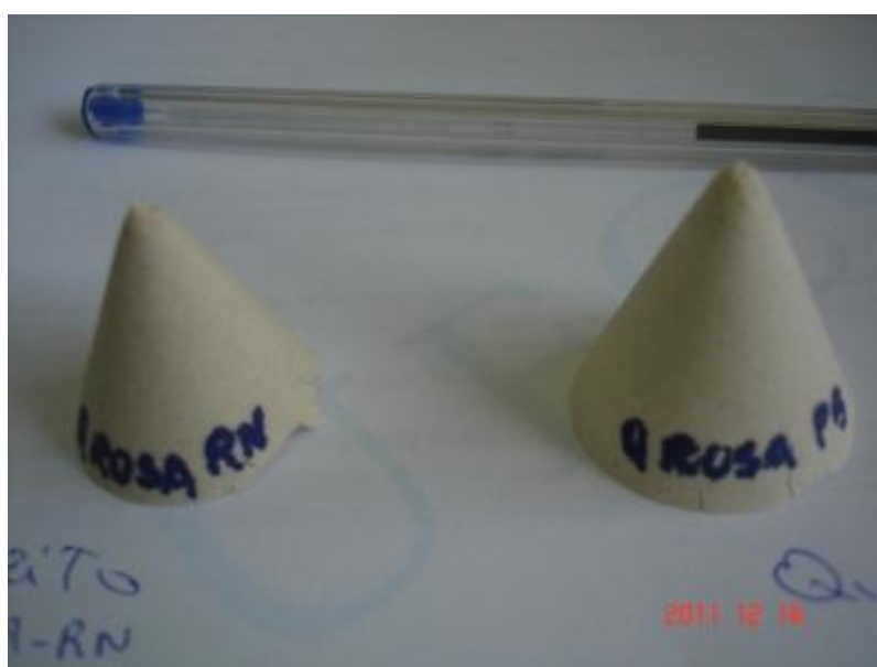
Figura 5 – Ensaios de fusibilidade com amostras de quartzito rosa.
