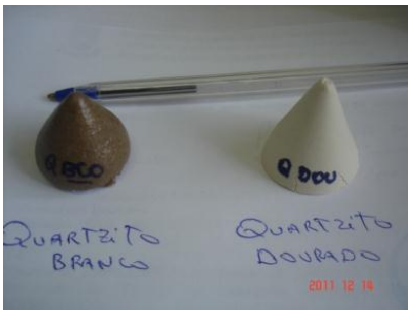
Figura 4 – Ensaio de fusibilidade com amostras de quartzito branco e quartzito dourado.
