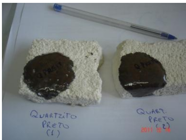
Figura 7 – Ensaio de fusibilidade com amostras de quartzito preto.
