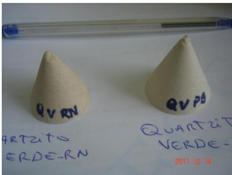
Figura 6 – Ensaio de fusibilidade com amostras de quartzito verde.
