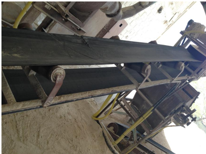
Figura 3 – Detalhe da correia transportadora alimentando o britador de martelos, na unidade de beneficiamento da cooperativa Coomipel.
