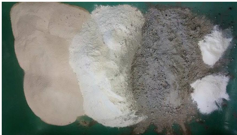
Figura 2 - Componentes utilizados para composição da argamassa. De esquerda para direita: areia de quartzo, resíduo de caulim, cimento Portland, e aditivos.
