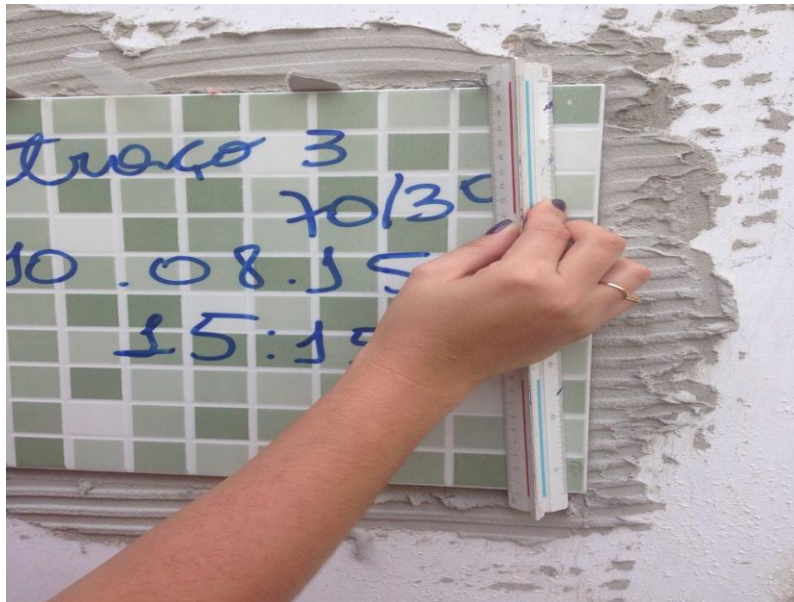
Figura 6 – Detalhe do ensaio de deslizamento.
