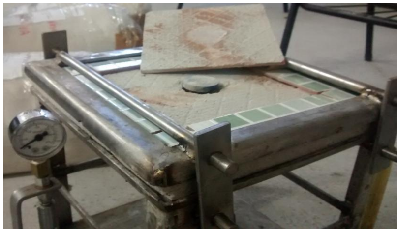
Figura 5 - Ensaio de resistência ao arranque por tração simples.
