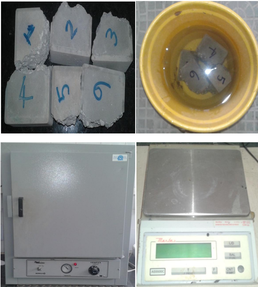
Figura 8 – Ensaio de absorção de água, mostrando detalhes do: a) fragmentos do corpo de prova; b) pedaços do bloco mergulhados em balde com água potável; c) estufa; e d) balança.
