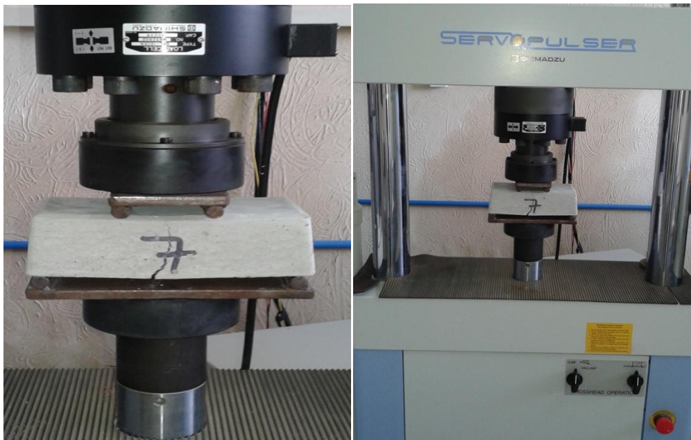
Figura 7 – Ensaio de Resistência à Tração na Flexão, mostrando detalhes do corpo de prova colocado no equipamento.
