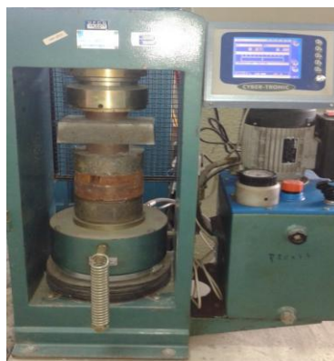
Figura 6 - Ensaio de resistência à compressão, mostrando detalhes do corpo de prova colocado no equipamento.
