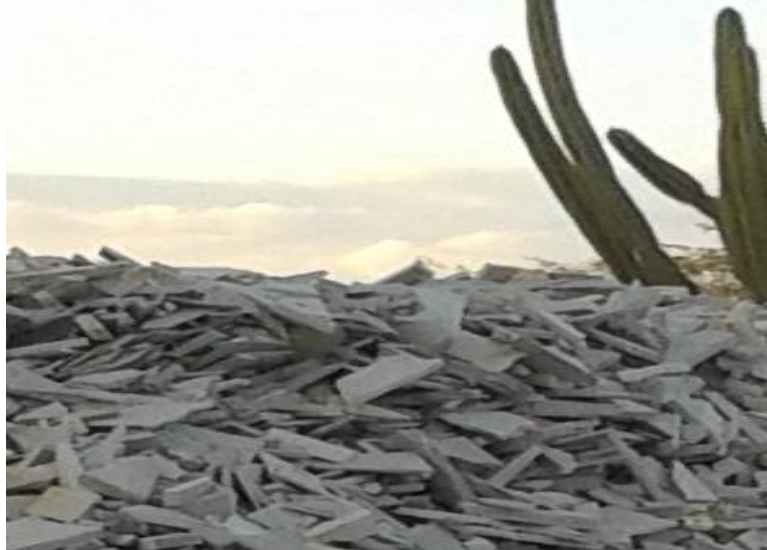
Figura 1 – Serraria do município de Várzea/PB com pilha de resíduos gerados no corte de quartzitos, constituídos por aparas, lascas, tiras e outros. Fonte: Própria.
